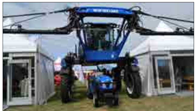
Met sy rolstaaf verwyder pas die kompakte New Holland-boordtrekker gemaklik onder die Guardian-spuiter. Die trekker is die TD 3.50F-model met twee- of vierwiel aandrywing vir boorde en wingerde en die hoogloper is die SP310F-model waarvan die onderstel 1,98 m bo die grond staan.
