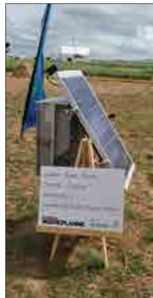
André Kirsten van Oranjerfontein by Darling se rooikatjaer het ‘n spesiale prys by Nampo Kaap se Boereplanne ontvang. Dié apparaat speel snags ‘n radiostasie by die skaapkuddes in die veld en word met sonkrag aangedryf.
