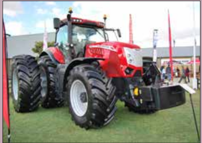
Die McCormick X8.680 het uitgetroon by Argo Industrial se 2018-uitstalling op Nampo. Standaard kenmerke van dié rooi reus met 224 kW enjinkrag sluit 'n driepunt-hyser en kragaftakker vooraan, kaguitvering en vering op die vooras in.
